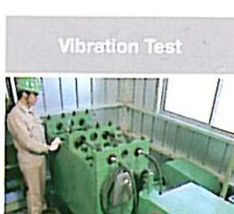
A vibration flexion is repeated one million times using a vibration testing machine. No leaks or problems were noted. / 利用震动测试机重复百万次震动测试。没有发现泄漏或问题。/ Fleksi getaran diulang sebanyak sejuta kali menggunakan sebuah mesin ujian getaran. Tiada kebocoran atau masalah dikesan.
