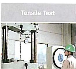
Drawing blocking power is measured using the Amsler universal testing machine. 0.2MPa (2.0kgf / cm<sup>2</sup>) of air pressure is applied into the enclosed pipe by a pump. / 采用 Amsler 环球测试机测量拉伸阻止力量。用泵把 0.2MPa (2.0kgf / cm<sup>2</sup>) 的气压注入钢管内。/ Penangan kuasa sekatuan diukur menggunakan mesin ujian semesta Amsler. Sebanyak 0.2MPa (2.0kgf / cm<sup>2</sup>) tekanan udara dimasukkan ke dalam paip yang disediakan dengan menggunakan sebuah pam.
