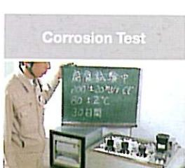
A testing solution consisting of 200+20mg/litre of Cl and distilled water is prepared according to JIS K8150 (sodium chloride reagent). / 根据 JIS K8150 (氯化钠剂) 的一项溶液测试，包含了 200+20 毫克 / 公升的 Cl 及蒸馏水。/ Larutan ujian yang terdiri daripada 200+20mg / liter Cl dan air suling disediakan mengikut kaedah JIS K8150 (reagen sodium klorida).
