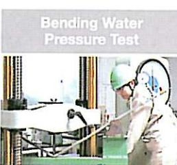
2.5 MPa of air pressure is injected and the maximum bending degree is measured using the Amsler universal bending machine. / 注入 2.5 MPa 的气压，然后采用 Amsler 环球测试机测量其最高弯曲度。/ Tekanan udara sebanyak 2.5 MPa dimasukkan dan darjah lenturan maksimum diukur dengan menggunakan mesin lenturan semesta Amsler.
